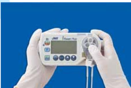
専用輸液セットのカセットを、ポンプに正しく装着し、クランプを開けて、プライミングします。
