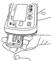
4. 交換するバッテリーを印字部分が上向き状態で挿入します。
