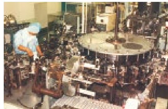
輸液セット自動組み立て機
